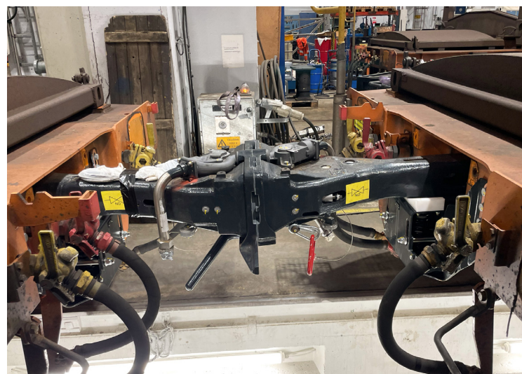
Die digitale automatische Kupplung (DAC) ist eine Schlüsselinnovation im europäischen Schienengüterverkehr. Wer finanziert die Umrüstung? (Bild: DAC KnorrBremse)
