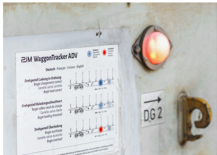
Signallampen auf dem Wagen visualisieren eine Überladung oder nicht korrekte Beladung. Foto: PJM
