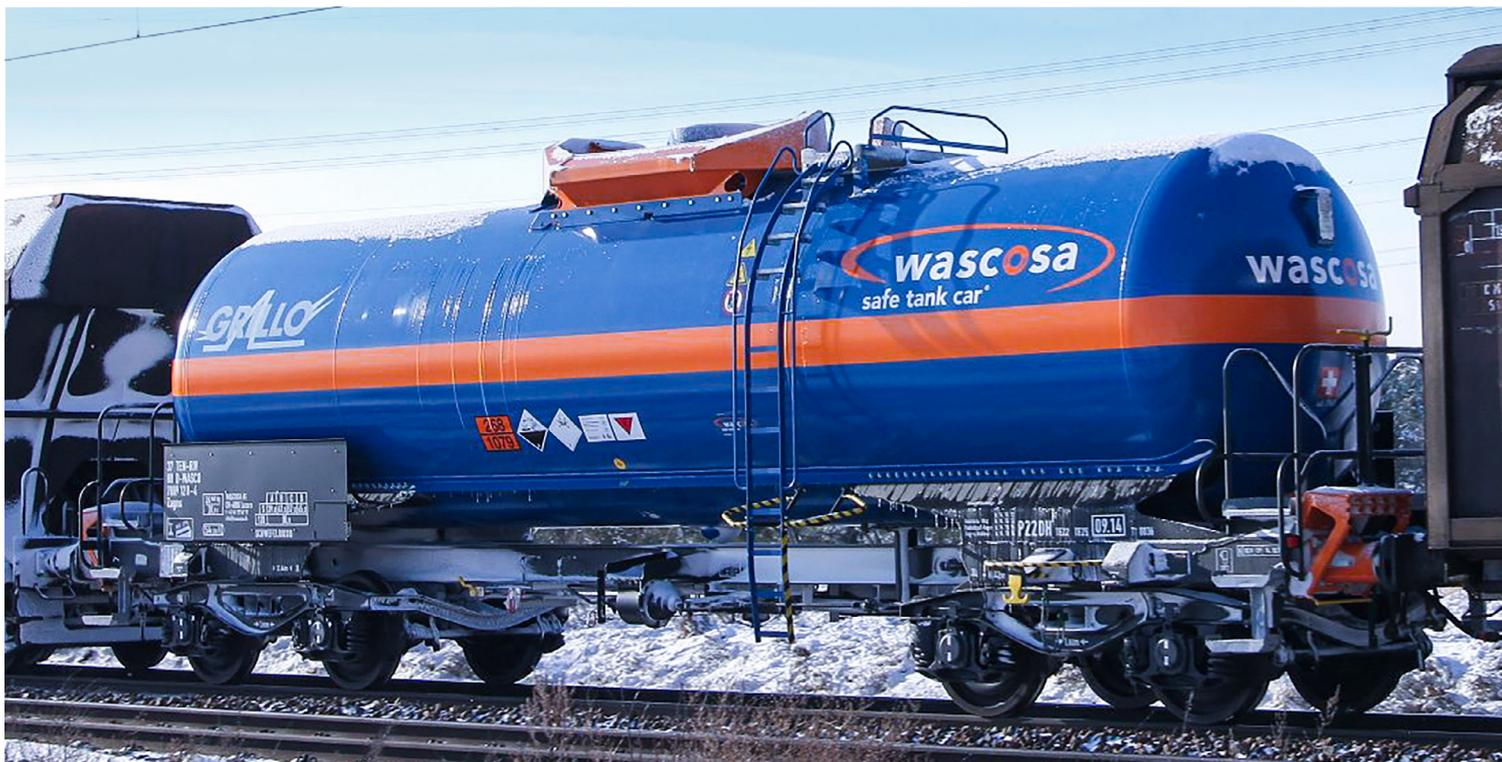
Der Wascosa safe tank car®, eine Produktinnovation für den Transport von Chlor und Schwefeldioxid.
