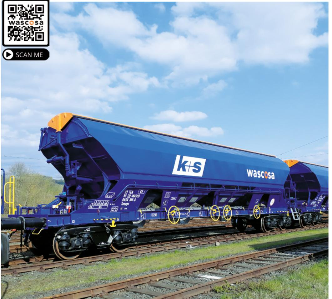
*Niedrige Entladezeit und hohe Flexibilität des Tanpps u.a. dank der in drei Richtungen drehbaren Entladeschurren.*
