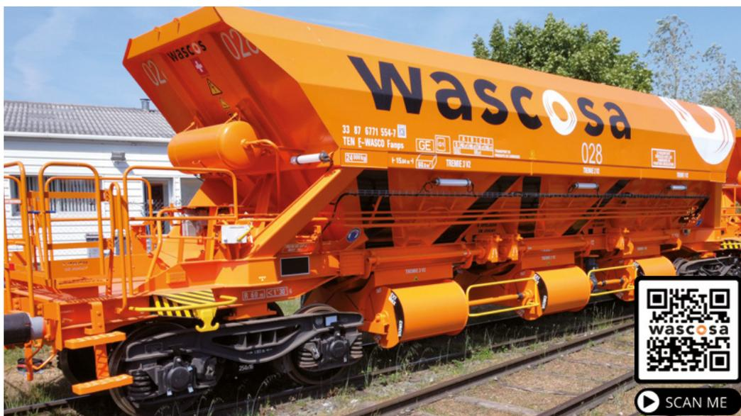
Ziel erreicht: Der automatisierte Schotterwagen Fanps macht die Arbeit der Gleiserneuerungsteams deutlich sicherer.
