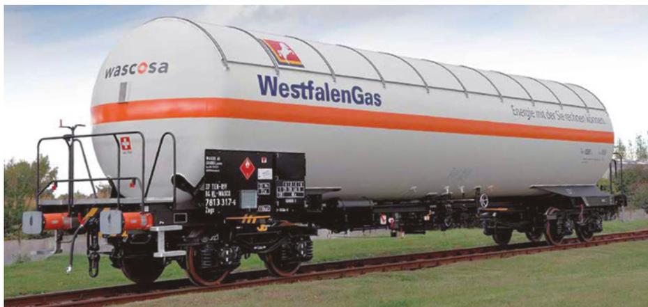
Positive Erfahrung: Die Westfalen AG bestellte Druckgaskesselwagen des Typs Zags von Wascosa.
