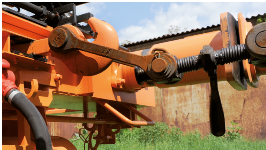
Im Schienengüterverkehr ist Europa der letzte (ganze) Kontinent, auf dem noch Schraubenkupplungen eingesetzt werden.
