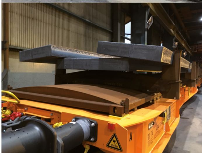
Das Wascosa flex freight system® im Einsatz mit Aufbauten für den Stahltransport sowie den Schienenbau.
