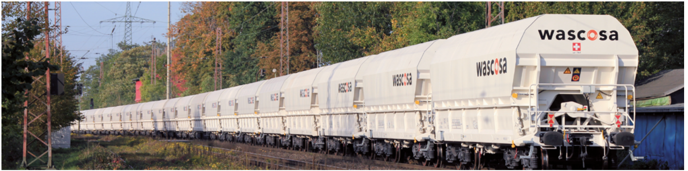
Die fabrikneuen, weissen Drehgestell-Schüttgutwagen Falns für thyssenkrupp Steel Europe.
